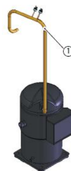
Rys. 4: W trakcie prawidłowej pracy rura ciśnieniowa (1) powinna być gorąca.
