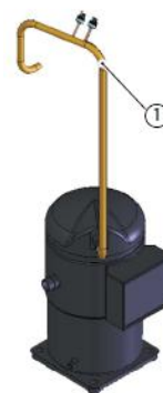
Rys. 4: W trakcie prawidłowej pracy rura ciśnieniowa (1) powinna być gorąca.
